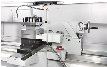
Leichte Handhabung: zum Positionieren kann der Reitstock an den Support gekoppelt werden
